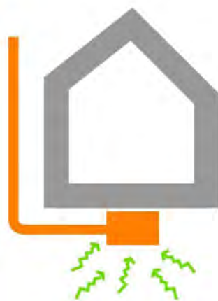
Figura 13: depressione del sottosuolo tramite pozzetto.
